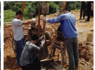
图 5 动力触探试验
