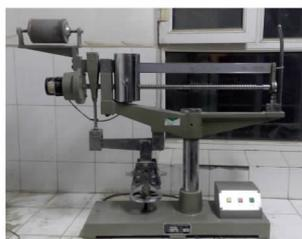
图8 电动抗折试验机
