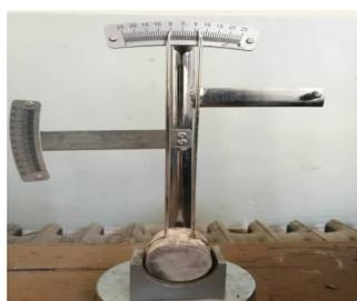
图 4 雷氏夹法膨胀测试
