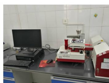
图 6 气流干法激光粒度仪
