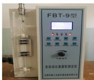
图 5 全自动比表面积测试仪
