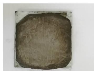
图 3 试饼法膨胀测试
