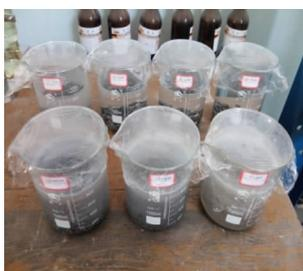
图 1 钢渣的浸水陈化处理
