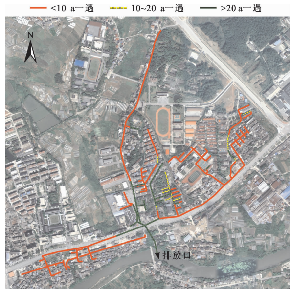
图 9 研究区排水管网排水能力分级图
