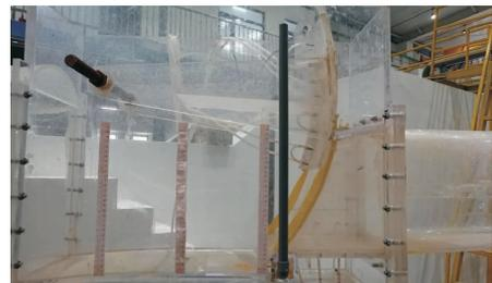
图1 弧形闸门面板水力学模型及测点布置
