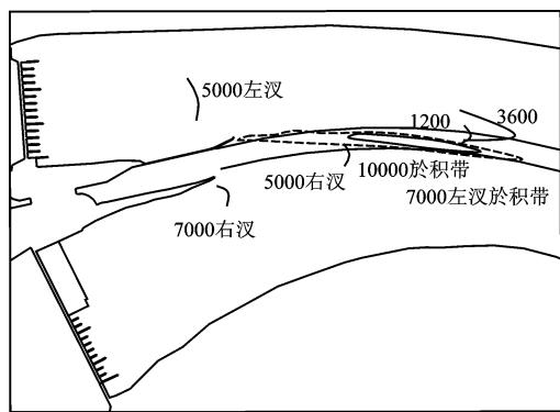
图 5 各级典型流量下淤积体前坡止动位置(单位: $\text{m}^3/\text{s}$ )
