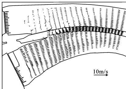
图 3 仅电站发电期( $Q = 3\ 600\ m^3/s$ )汇流段流场
