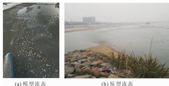
图 2  $Q = 400 \text{ m}^3/\text{s}$  时船闸下游航道附近模型流态与原型流态
