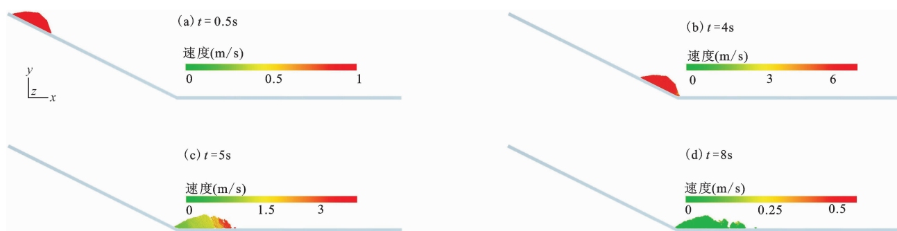
图 7 不同时刻含水堆积体滑动速度分布 ( k = 4\,000\text{ J/m}^3 )
