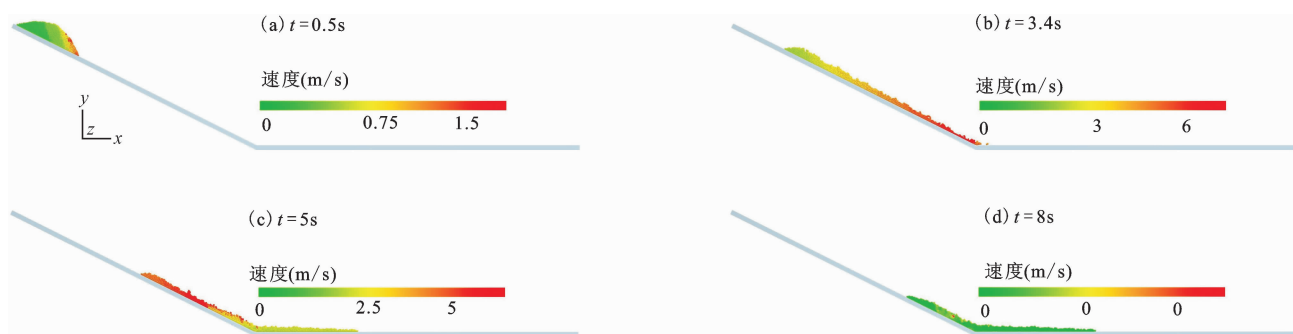
图 5 不同时刻含水堆积体滑动速度分布 ( k = 1\,000\text{ J/m}^3 )
