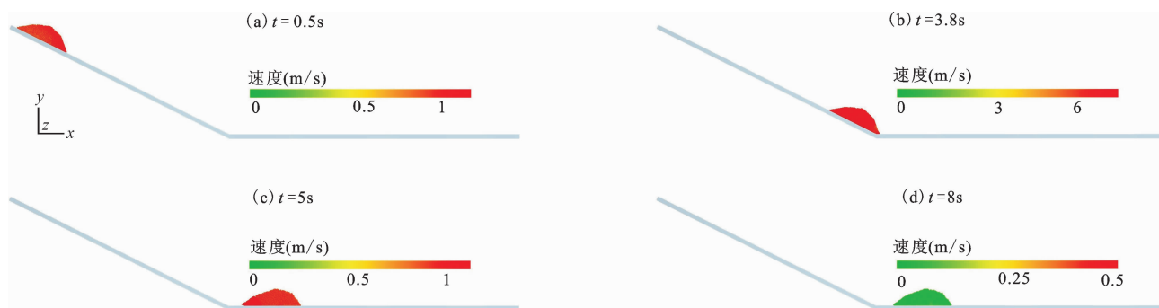
图8 不同时刻含水堆积体滑动速度分布( k = 6\,000\text{ J/m}^3 )
