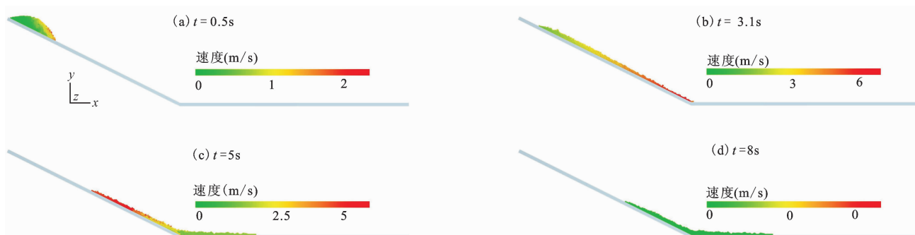
图 4 不同时刻干燥堆积体滑动速度分布 ( k = 0 )
