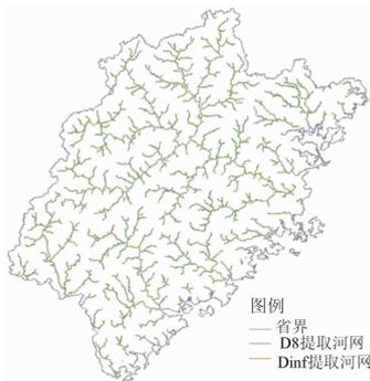
图 7 SRTM 数据 D8 与 Dinf 算法提取的河网对比
