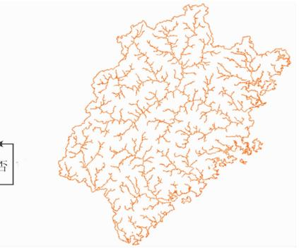
图 6 基于 Dinf 算法提取的河网
