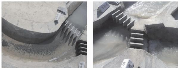
图5 进水闸底板高程优化后水流流态
