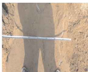
图 9 2.5 MPa 的压密 直径 0.603 m
