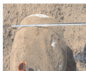
图 11 4.0 MPa 的压密 直径 0.817 m
