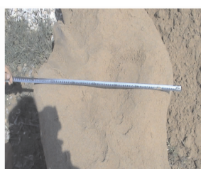
图 10 3.0 MPa 的压密 直径 0.693 m
