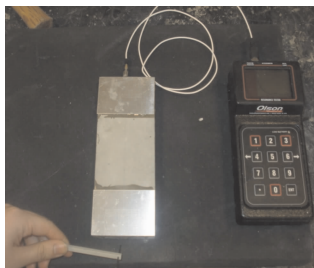
图 2 共振频率试验装置
