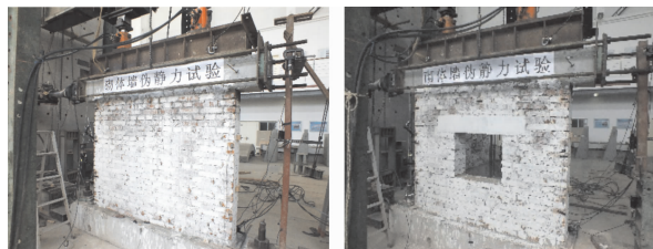
(a) 不开洞墙体(Q2) (b) 开洞墙体(Q3)
