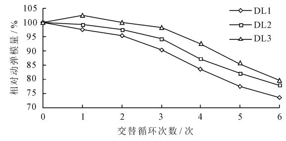
图 6 各组试件相对动弹模量曲线
