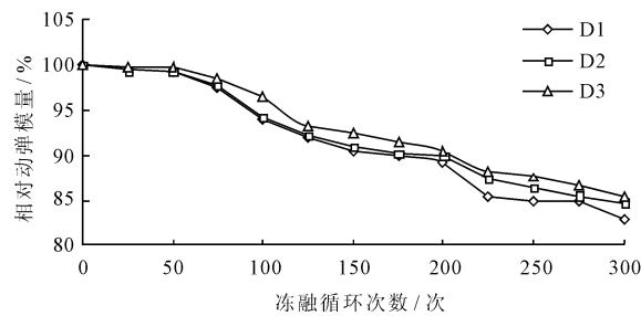
图 4 各组试件相对动弹模量曲线
