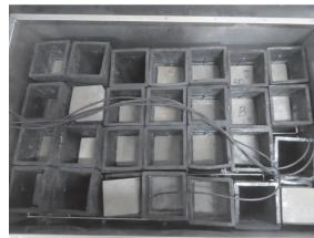
图 1 冻融循环试验现场      图 2 硫酸盐侵蚀试验现场
