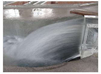
图5 推荐挑坎导流工况 1871.75m 闸门全开水舌流态
