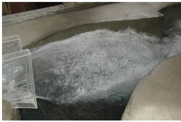
图3 推荐挑坎 1933.46m、闸门开度 2.7m 水舌流态
