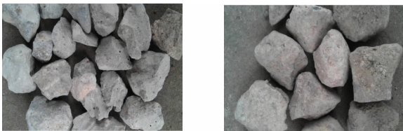
图1 水泥板破碎后粗集料 图2 水稳基层铣刨料粗集料
