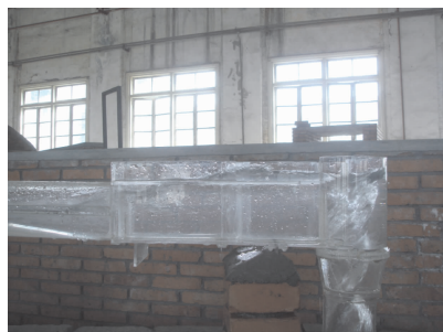
图 2 圆弧涡室流态
