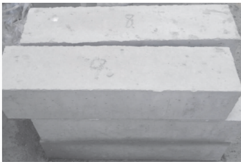
图 2 建筑垃圾微粉作掺合料的混凝土抗折试块
