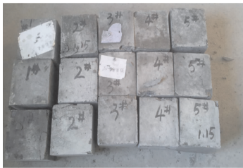
图 1 建筑垃圾微粉作掺合料的混凝土抗压试块
