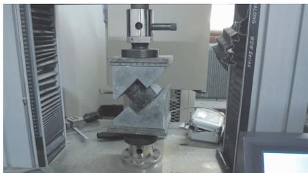
照片 1 固定  $45^{\circ}$  角剪切面剪切试验
