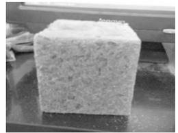
图4 粗骨料外露试件
