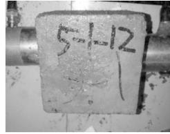
图3 出现裂纹试件
