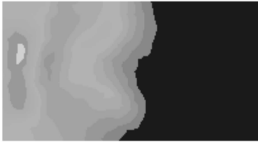
图 11 四管截面处气相分布云图
