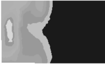
图 8 三管截面处气相分布云图
