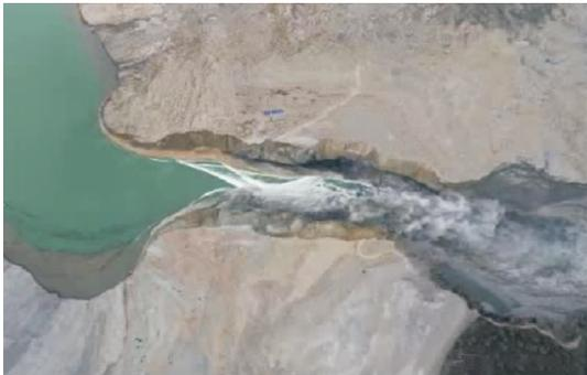
图1 2018年“11.03”白格堰塞湖引流槽泄洪图<sup>[16]</sup>
