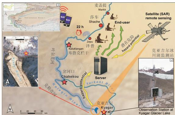
图 1 克亚吉尔冰川湖监测站示意图<sup>[10]</sup>
