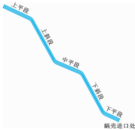
图 1 引水管道沿程荷载施加位置示意图
