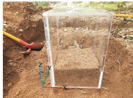
图 1 试验原状土现场取样<sup>[5]</sup>
