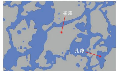
图4 进行仿真模拟的土样几何模型
