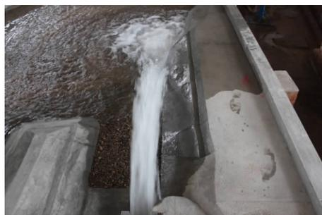
图1 原方案溢洪洞校核泄量工况水舌形态
