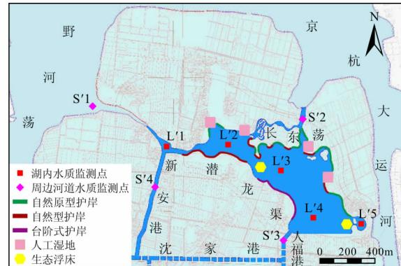
图2 潜龙渠形态调整后水质监测及生态修复工程点位图
