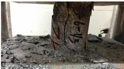
图 6 岩石单轴抗压试验
