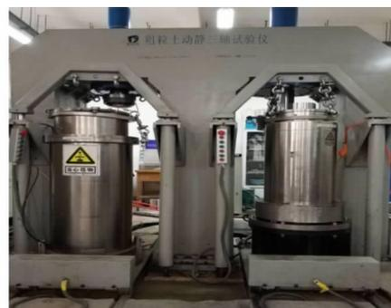
图 3 DTD-2000kN 微机伺服粗粒土动静三轴仪
