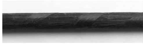
图 3 微压纹表面形式 CFRP 筋
