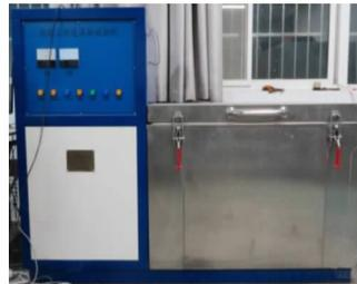
图 3 混凝土冻融试验机
