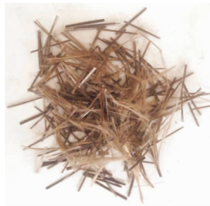
图1 试验用玄武岩纤维
