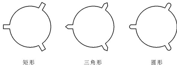
图1 螺旋侧板的截面形状
