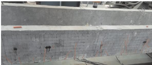
图 5 试验结束时腹板最终裂缝情况
