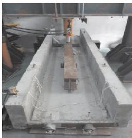
图3 千斤顶加载装置图
