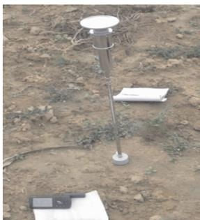
图 2 表土比贯入阻力试验
