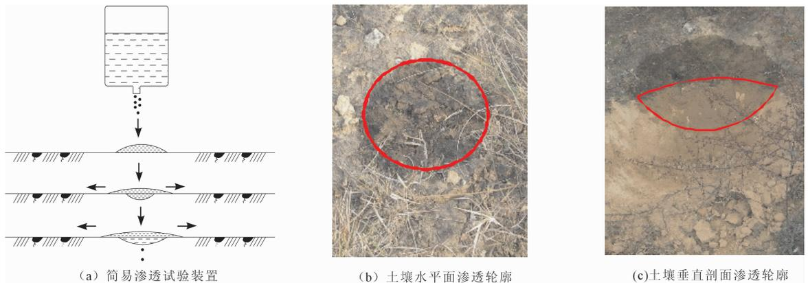
图 1 简易渗透装置示意图及渗透轮廓
