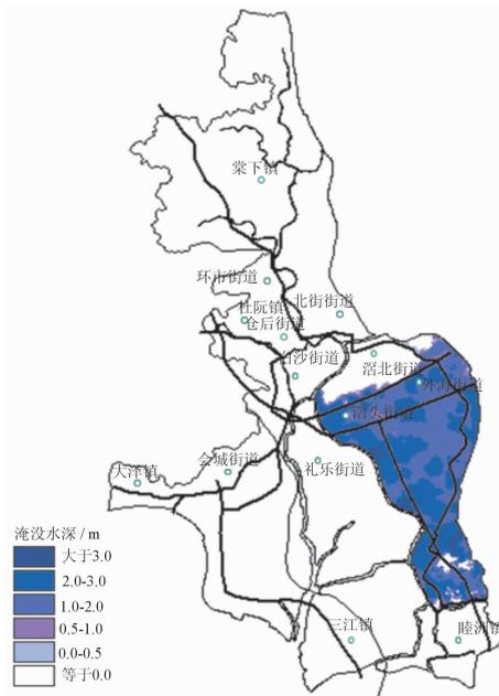
图9 黄字围溃口最大淹没水深图
