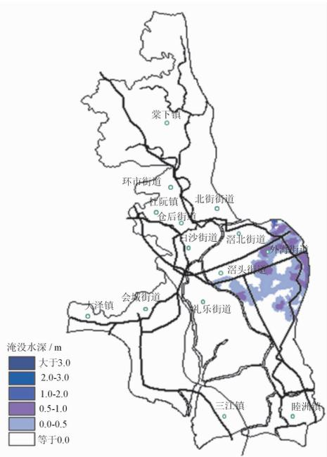
图8 清栏溃口最大淹没水深图
