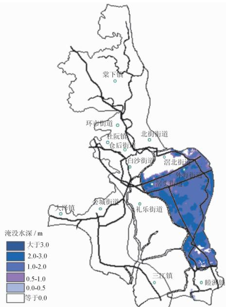
图10 三溃口联溃最大淹没水深图
