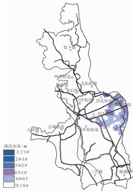
图7 北街水闸下游溃口最大淹没水深图
