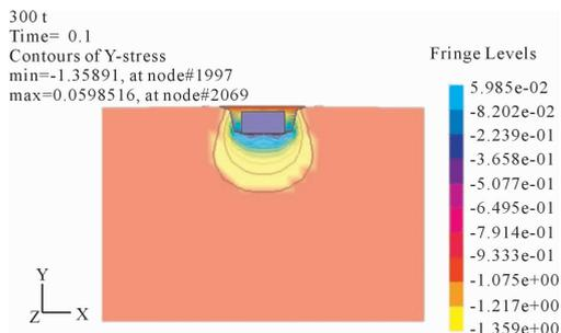
图10 300 t·m 第七击0.1s 竖向位移云图(单位:m)
