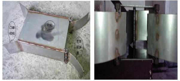
图9 变角度导流试验装置
