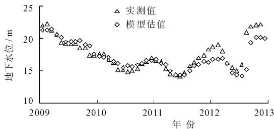
图 3 2009 - 2012 年 1 月份水位实测值与模拟结果动态曲线
