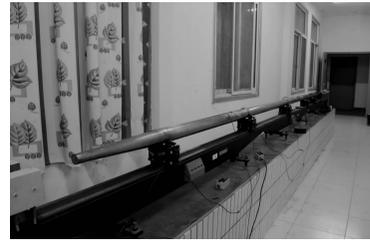
图 2  $\phi 74$  mm 变截面 SHPB 试验装置
